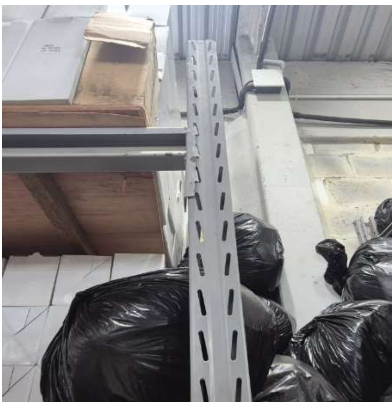
FOTO 024- FIXAÇÃO DAS LONGARINAS E OBJETOS APOIADOS DIRETAMENTE NELA P04.
