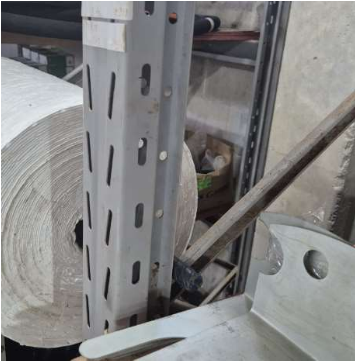
FOTO 029- OBJETO APOIADO NO TRAVAMENTO DIAGONAL P05;P04.
