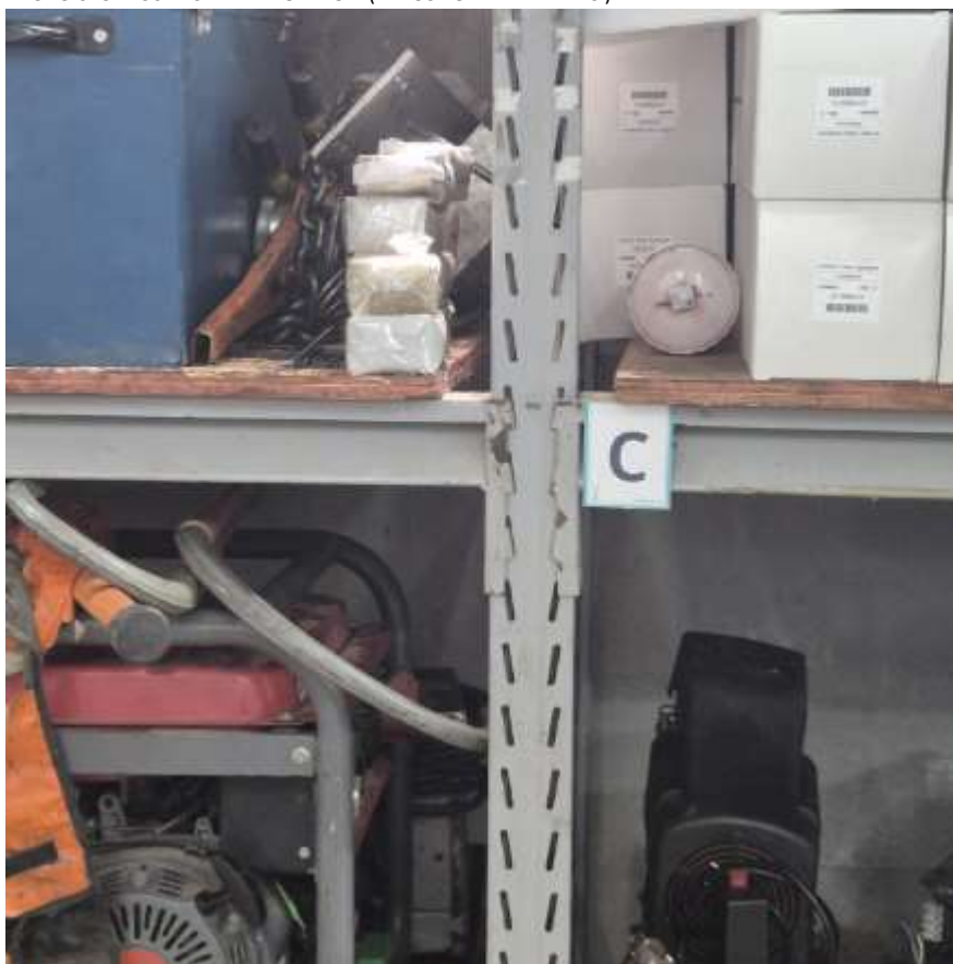
FOTO 014- OXIDAÇÃO NO TRAVAMENTO DAS LONGARINAS P01 E P02.
