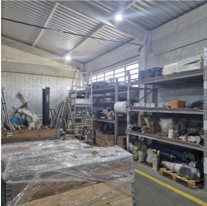
FOTO 019- EXCESSO DE CARGA P07; P08 E P09.
